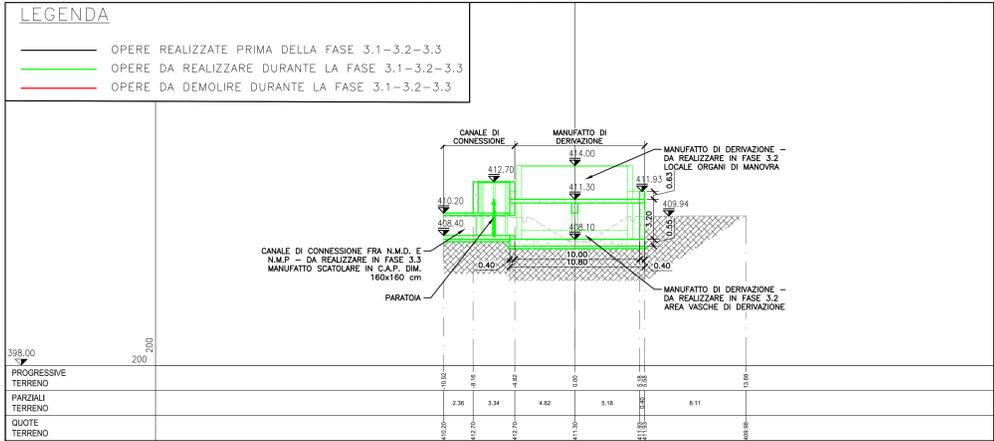
SEZIONE TRASVERSALE E-E - BYPASS NORD - FASE 3.4 DI 6 - SCALA 1:200
