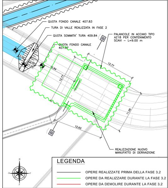
PLANIMETRIA DI CANTIERIZZAZIONE - BYPASS NORD - FASE 3.4 DI 6 - SCALA 1:200
