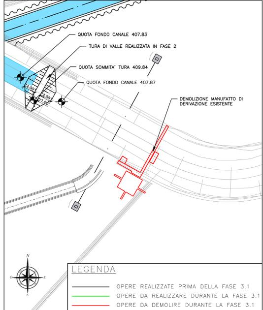
PLANIMETRIA DI CANTIERIZZAZIONE - BYPASS NORD - FASE 3.3 DI 6 - SCALA 1:200
