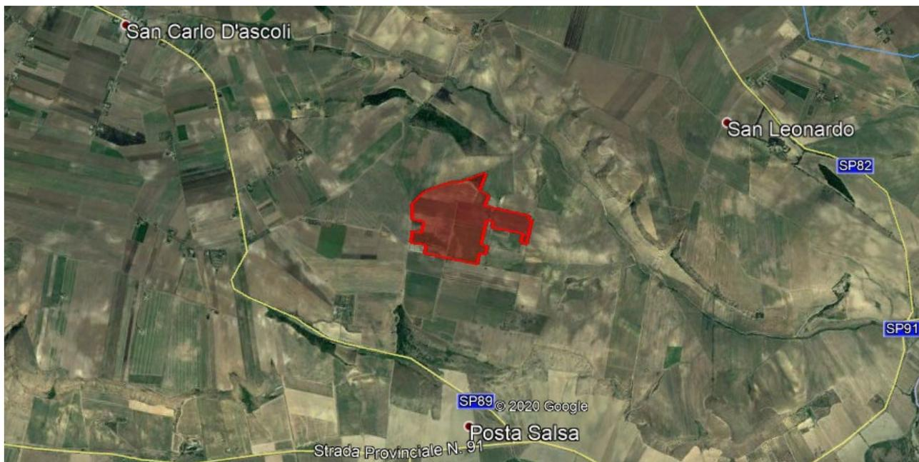
L'impianto fotovoltaico in progetto prevede l'installazione a terra, su un unico lotto di terreno di estensione complessiva di circa 480.000 m<sup>2</sup> attualmente a destinazione agricola condotti a seminativo, di pannelli fotovoltaici (moduli) in silicio monocristallino della potenza unitaria di 495 Wp.
