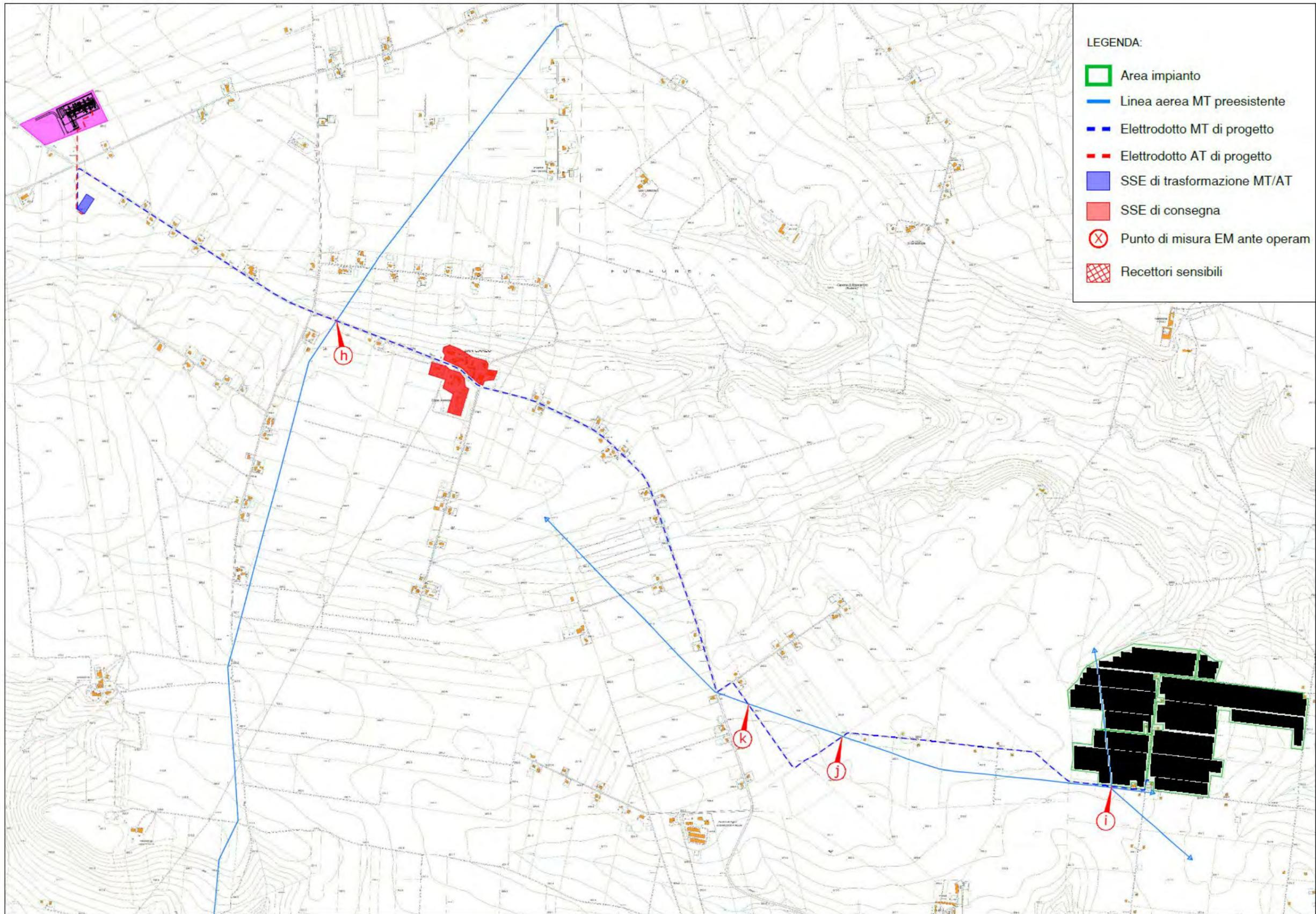
Figura 52 Stralcio planimetrico con rappresentazione del tracciato dell'elettrodotto MT di progetto.
