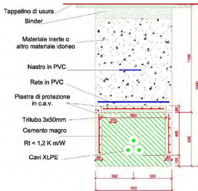
**Figura 64 Sezione tipo di posa dei cavi elettrici**
