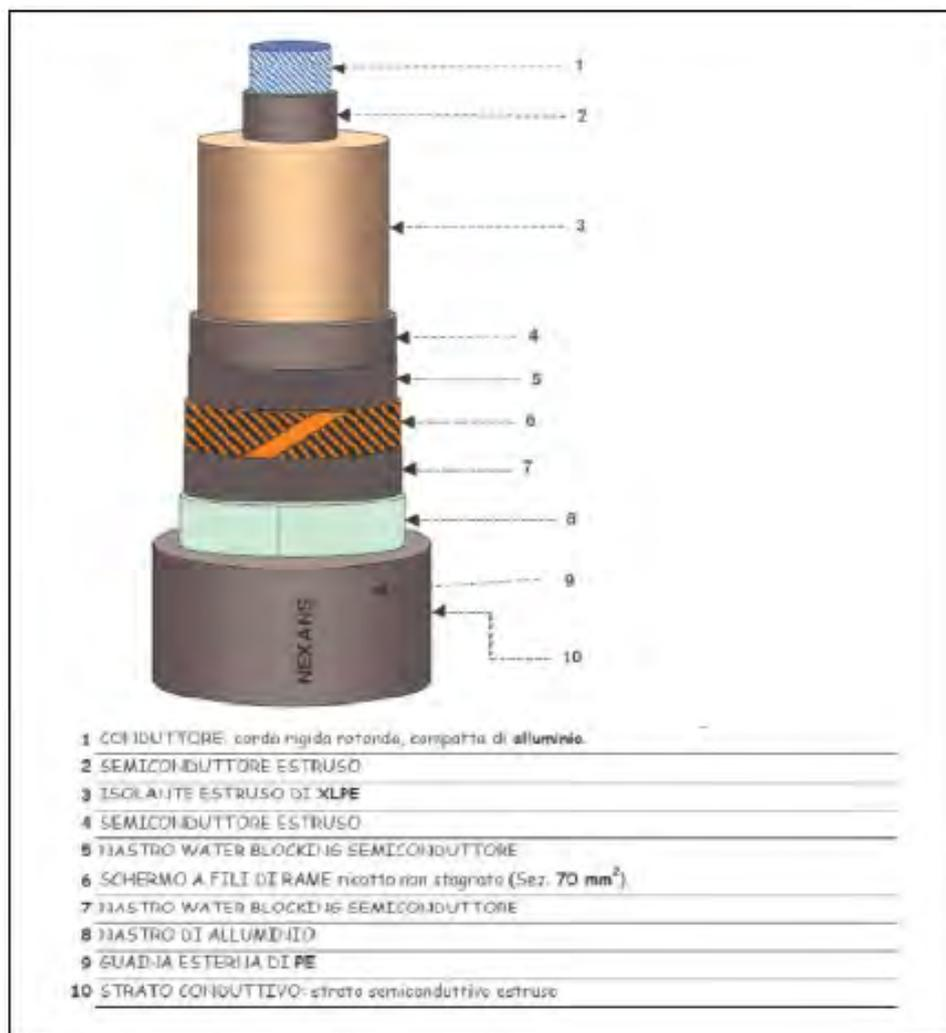
**Figura 38 – Schema tipologico del cavo**
