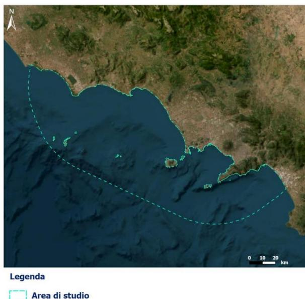
**Figura 5 - Area di studio per l'intervento di inserimento di nuovi cavi marini HVDC collegando Montecorvino e Latina**
