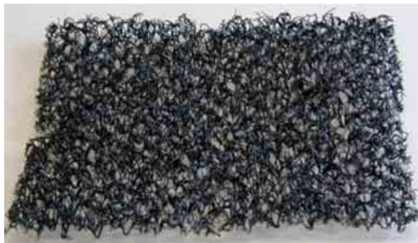
Figura 5-2: Esempio di struttura di geostuoia
