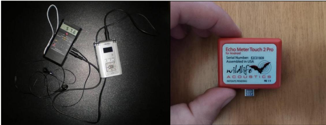
Foto 5.2.A - Bat-detector D240X con registratore digitale Edirol R-09 e Echo Meter Touch 2 Pro
