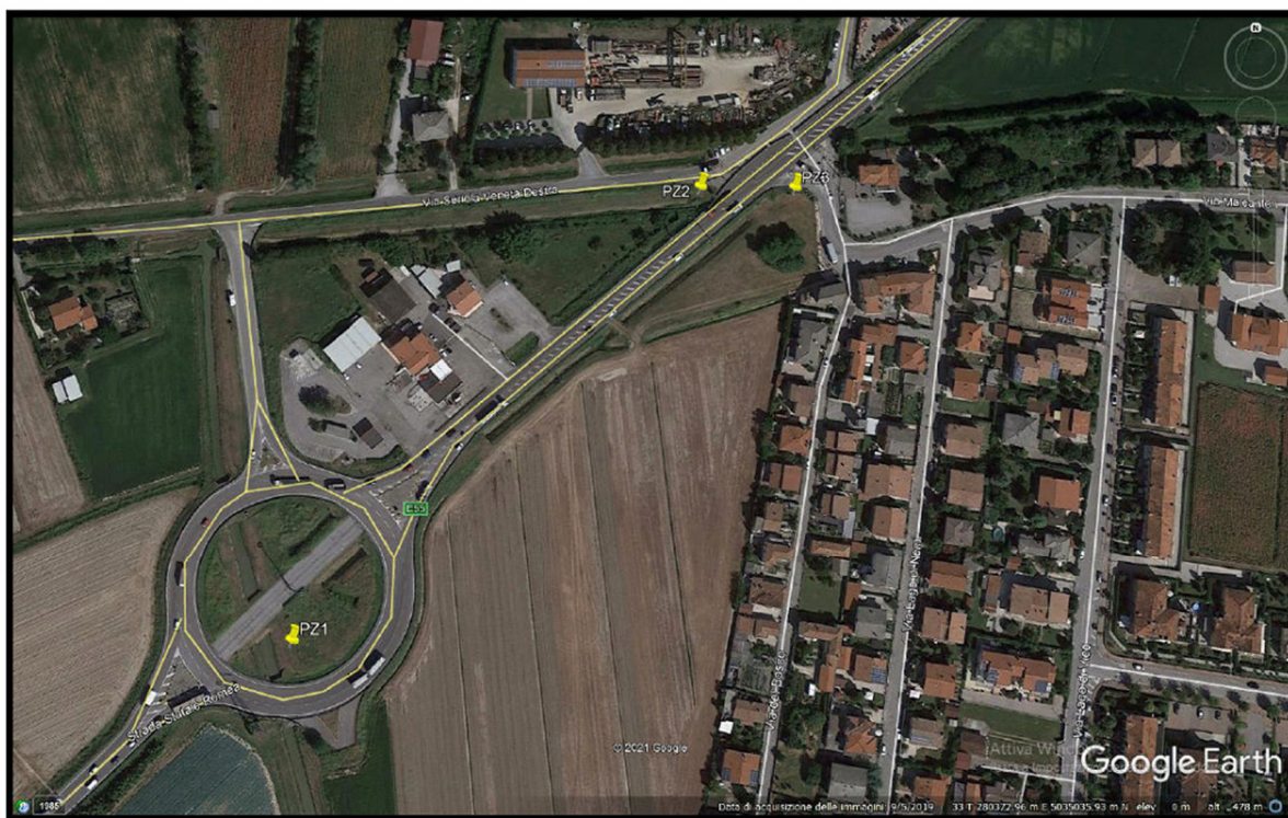
Figura 5 - Posizionamento dei piezometri.
