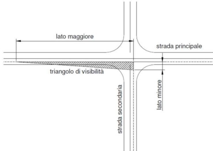
FIGURA 3 - SCHEMA DI VERIFICA DEI TRIANGOLI DI VISIBILITÀ DELLE INTERSEZIONI - D.M. 19/04/2006
