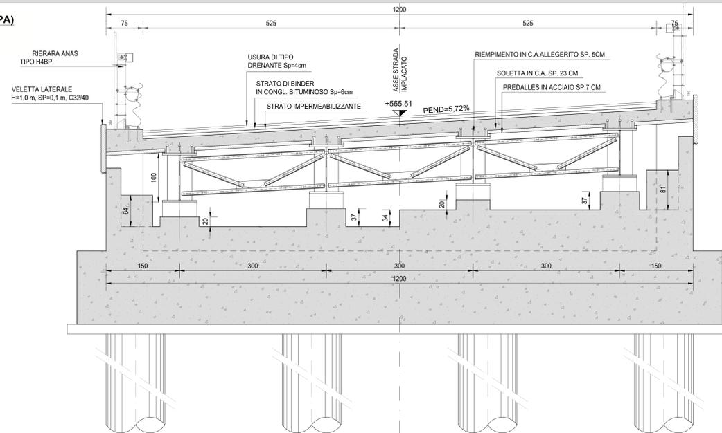
**SEZIONE TRASVERSALE DI IN CORRISPONZA DELLE PILE (P3)**
