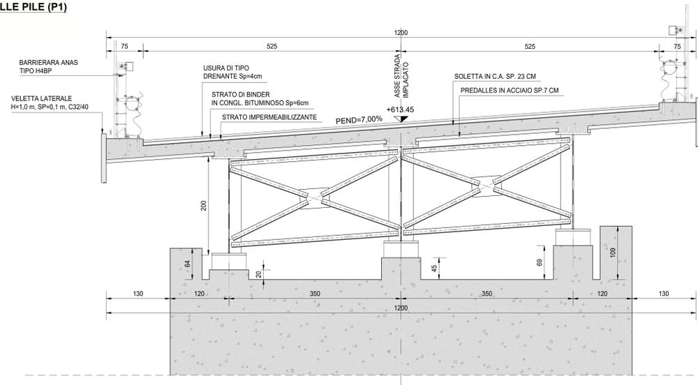
**SEZIONE TRASVERSALE DI IN CORRISPONZA DELLE SPALLE - (SPB)**
