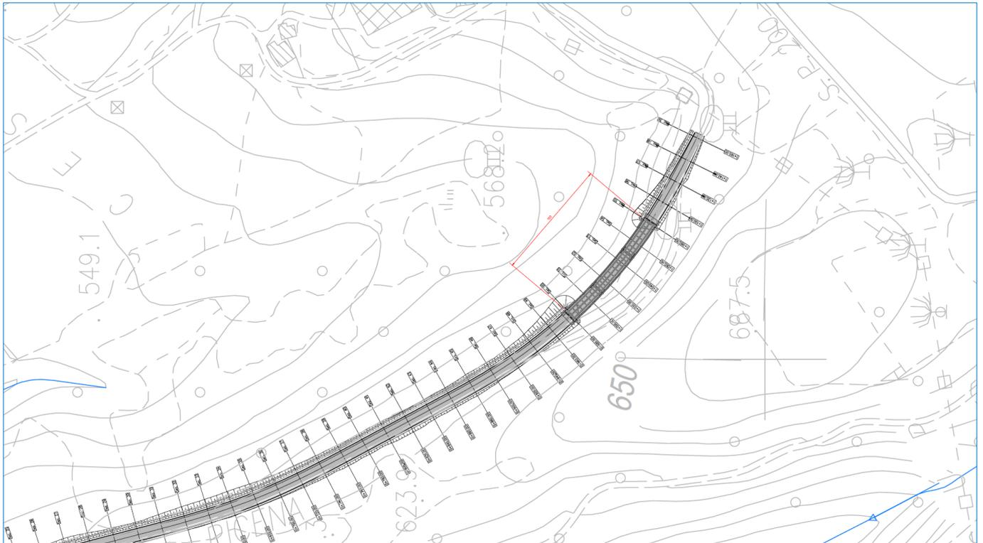
Il nuovo tracciamento ha previsto la realizzazione di un viadotto a n.3 campate di estensione complessiva pari a 100m (estensione misurata in asse appoggi spalla).
