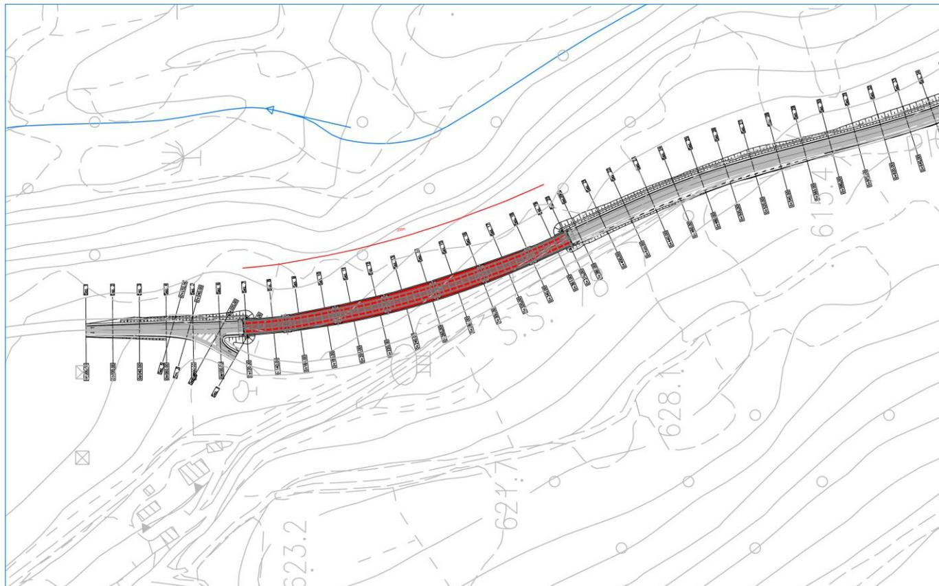
Il nuovo tracciamento ha previsto la realizzazione di un viadotto a n.7 campate di estensione complessiva pari a 250m (estensione misurata in asse appoggi spalla).
