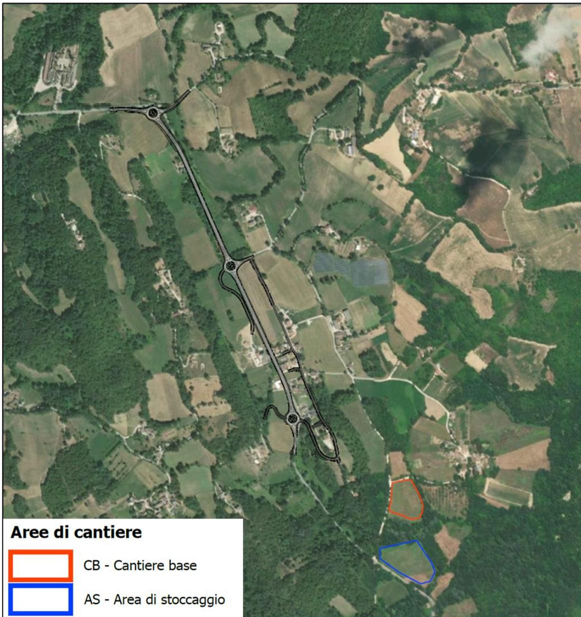
Figura 4-2 Stralcio della tavola "Cantierizzazione: ubicazione delle aree di cantiere e viabilità di servizio" (cod. elaborato T00IA02AMBCO02), localizzazione aree di cantiere fisso
