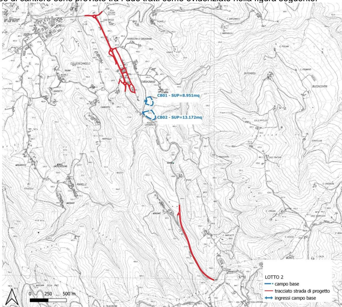
Figura 5-2 Localizzazione delle aree di cantiere
