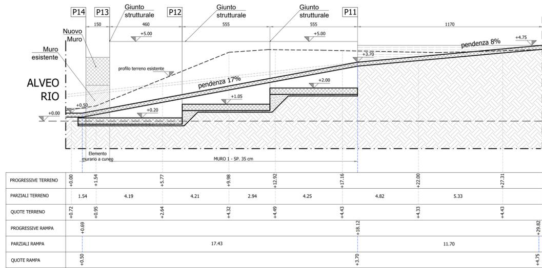
Profilo longitudinale rampa carrabile - sezione CC
