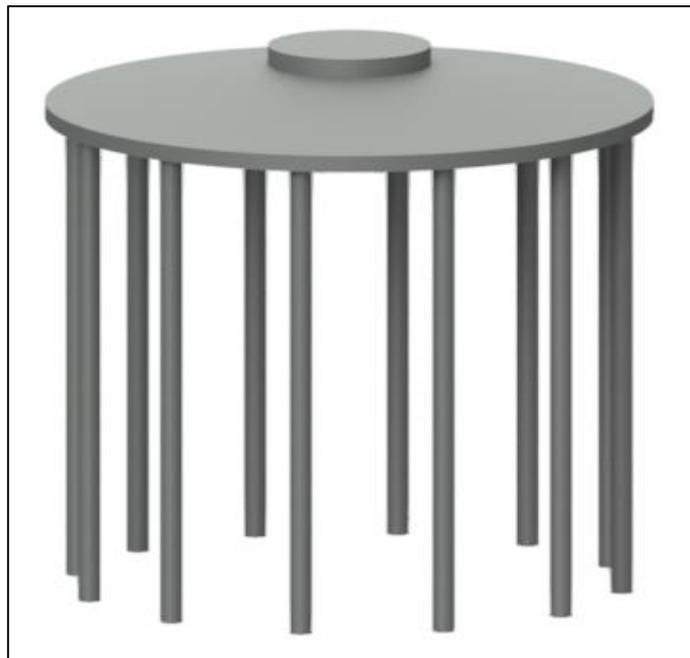
Figura 5: vista tridimensionale della fondazione dell'aerogeneratore
