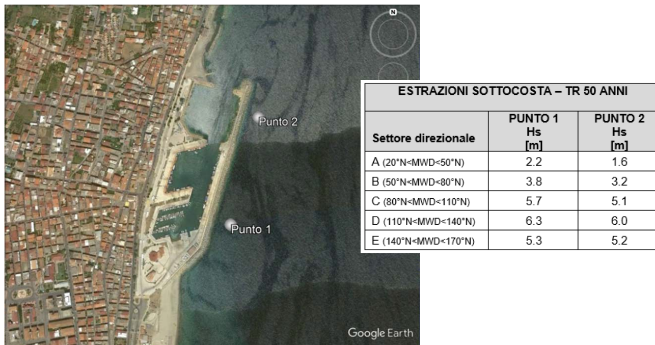
Figura 4-7 Ubicazione dei punti di estrazione in prossimità del molo di sopraflutto del Porto di Cirò Marina e Altezze d’onda estratte nei punti 1 e 2 per le onde cinquantennali al variare della direzione
