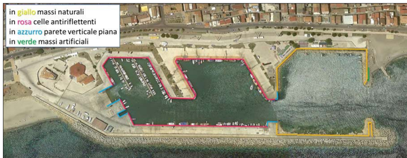
Figura 4-8 Illustrazione delle caratteristiche strutturali del bacino portuale
