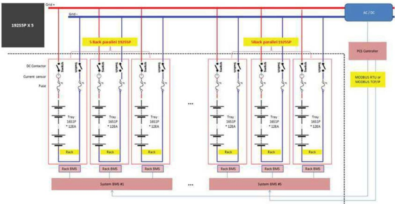
Figura 7 schema unifilare esemplificato di una stringa di batterie di accumulo
