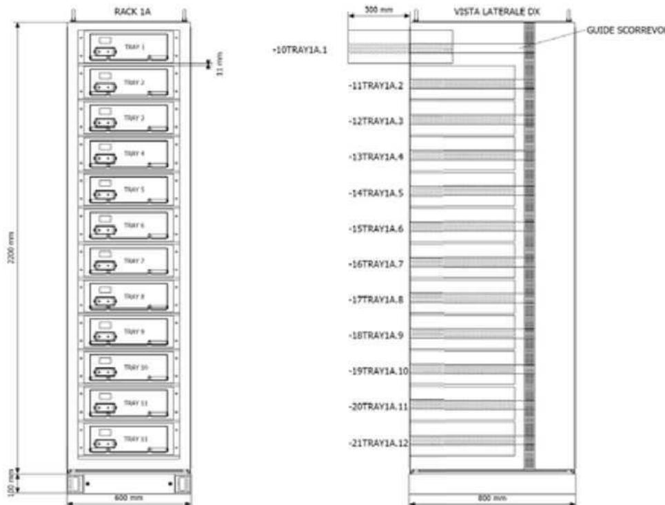
Figura 8 schema di un pack di batterie di accumulo
