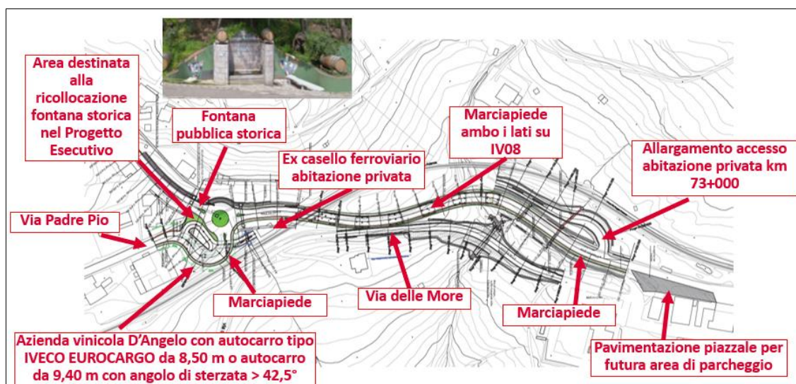
Figure 1-4 Planimetria della soluzione progettuale dell'NV08 con recepimento delle richieste avanzate dal Comune di Rionero in Vulture, di Barile e del Comitato dei cittadini
