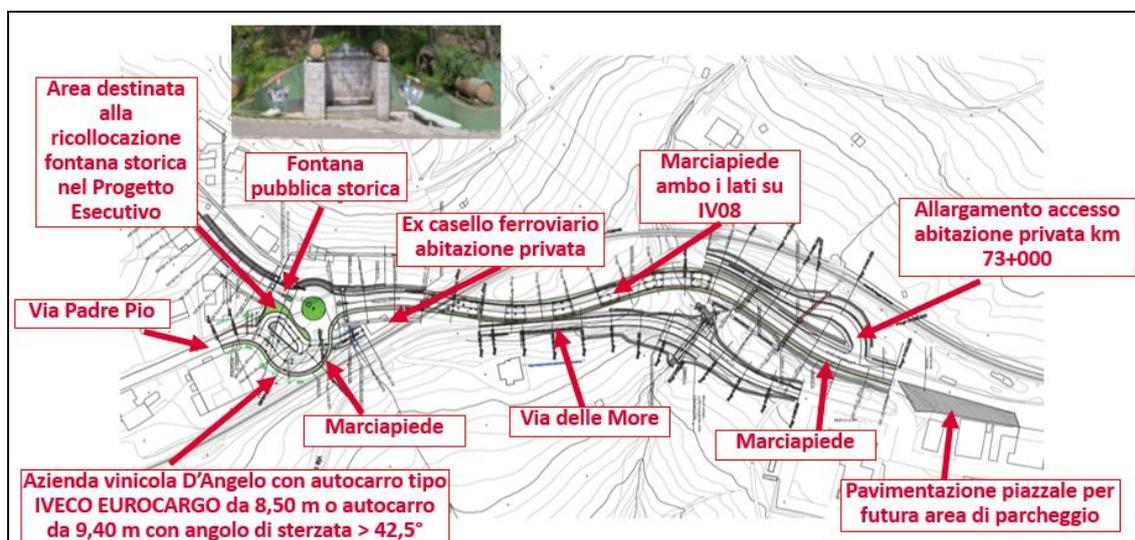
**Figura 4 - Planimetria della soluzione progettuale di PD dell'NV08 con recepimento delle richieste avanzate dal Comune di Rionero in Vulture, di Barile e del Comitato dei cittadini**
