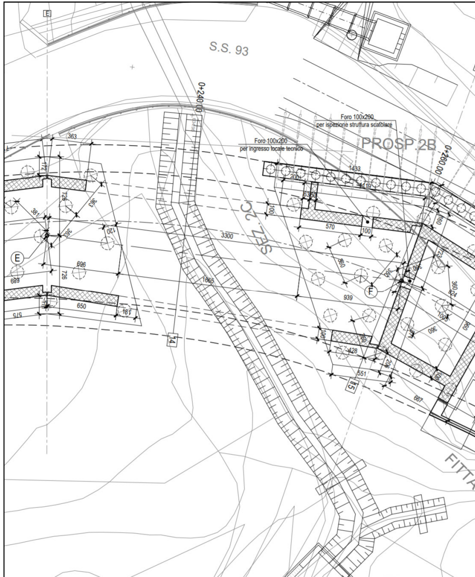
Figura 6 – IN05 - Sistemazione idraulica di monte
