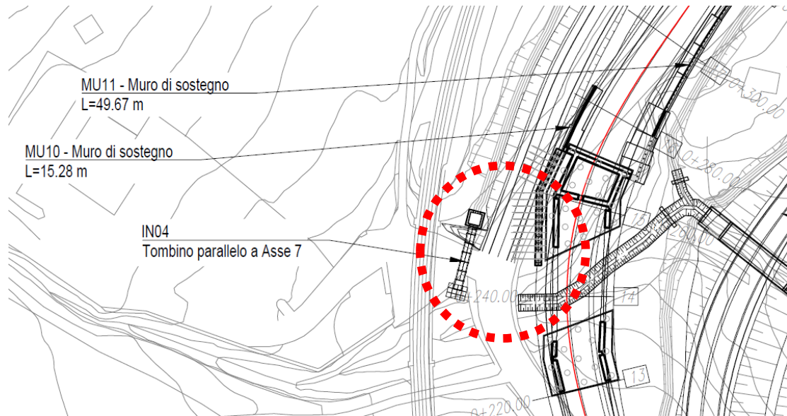
SS93 – restringimenti puntuali per realizzazione tombino IN04, e completamento ASSE 7
