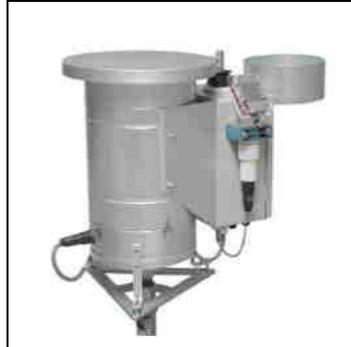
Tale apparecchio si attiva in assenza di precipitazioni raccogliendo il materiale sedimentato. Quest'ultimo viene poi valutato per microscopia ottica automatica dopo essere stato raccolto su adeguato vetrino di osservazione. La foto di seguito riportata si riferisce ad un campione di particolato atmosferico sedimentato.
