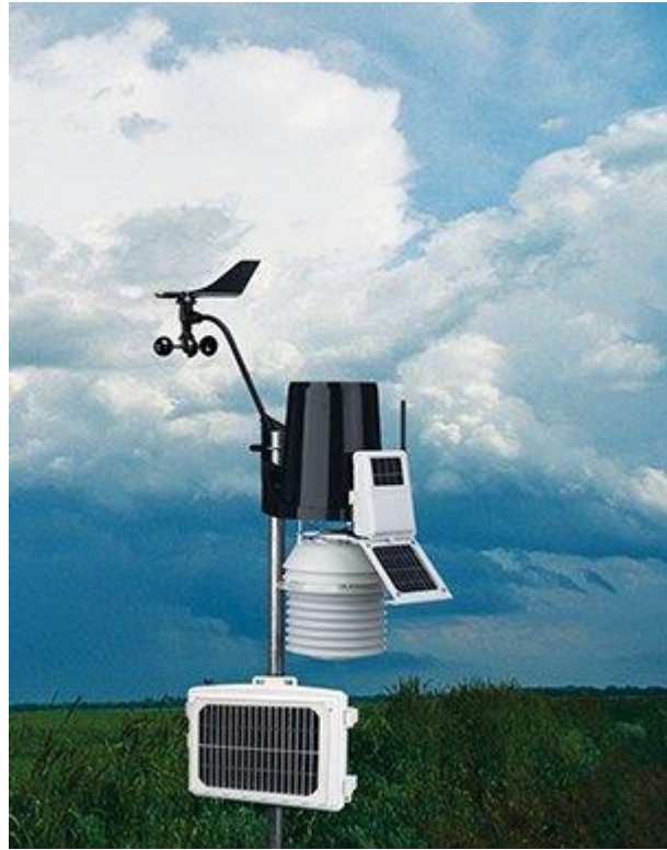
Esempio di stazione meteo completa alimentata da energia solare
