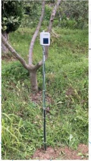
Sensore per rilievo dati di temperatura e umidità del suolo (parte infissa nel terreno)
