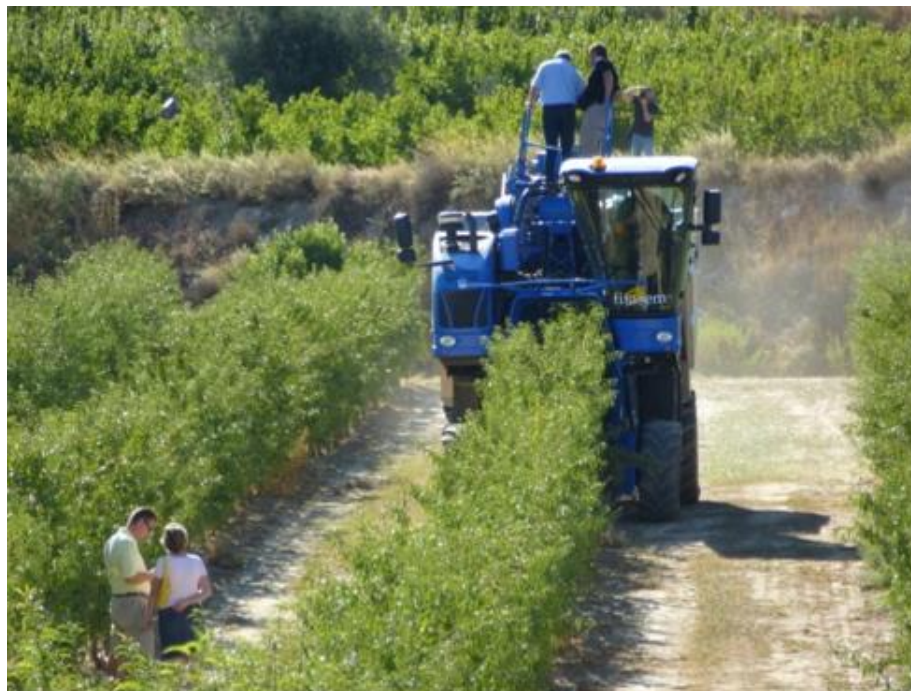
Foto 3 - Macchina scavallatrice durante le operazioni di raccolta in mandorleto superintensivo a siepone
