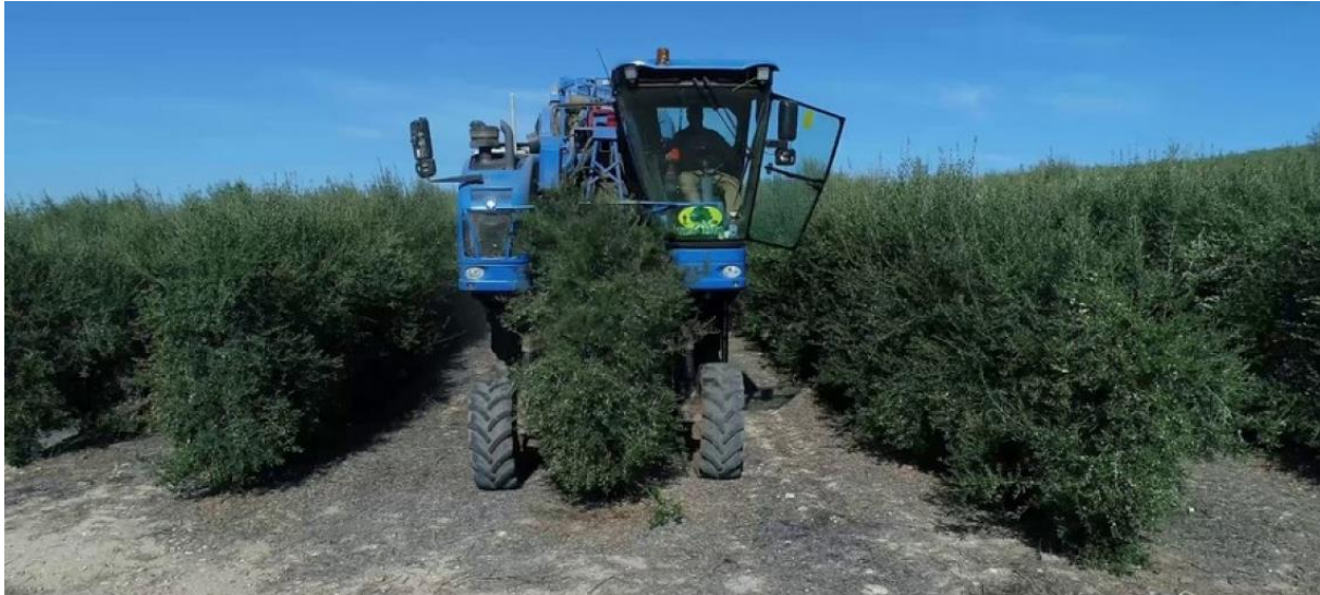
Foto 4 - Macchina scavallatrice durante le operazioni di raccolta in oliveto superintensivo a siepone
