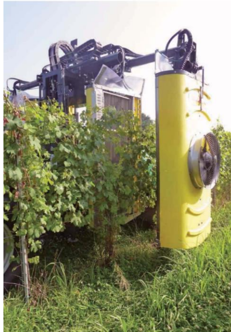
Foto 2 - pompa irroratrice a polverizzazione pneumatica con diffusore anti-deriva (usata anche per l'oliveto)
