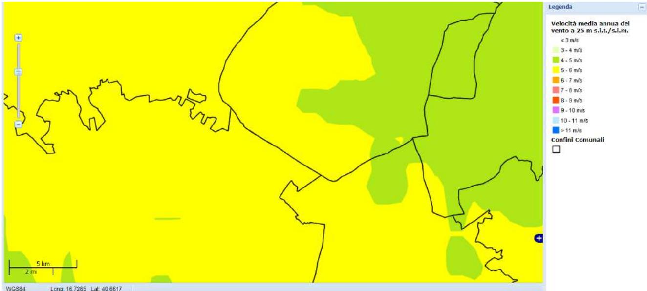
Figura 49 – Velocità media annua del vento a 25 m s.l.t./s.l.m. Fonte AtlaEolico, <http://atlanteolico.rse-web.it/>
