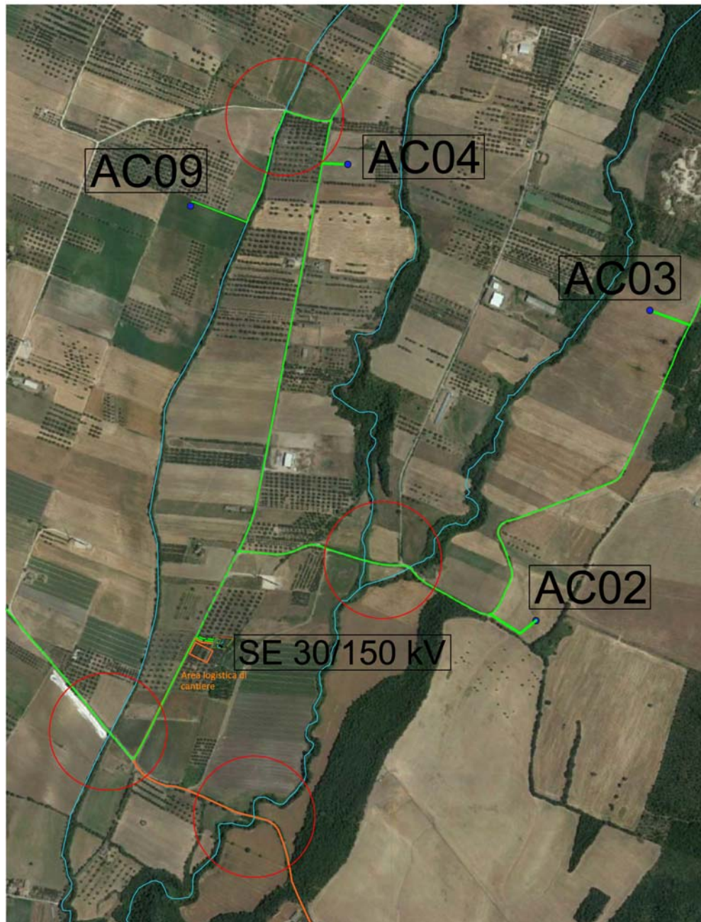
Figura 8 - Intersezioni del cavidotto con il reticolo idrografico su ortofoto - particolare WTG AC02 – AC03 – AC04 - AC09 – SE
