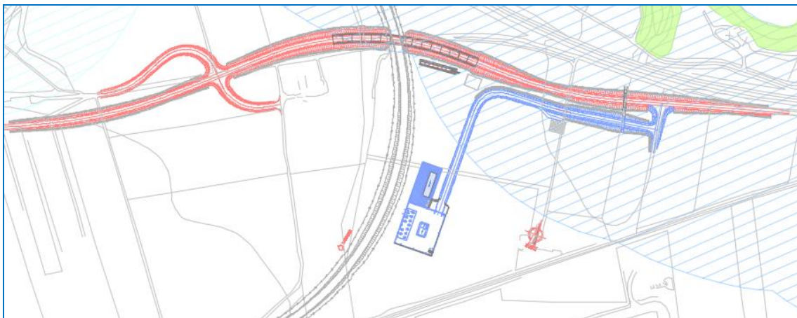
Figura 4 – Sovrapposto planimetrico variante SC14 in sottovia (in rosso) e opere del Raccordo Taranto (in blue)
