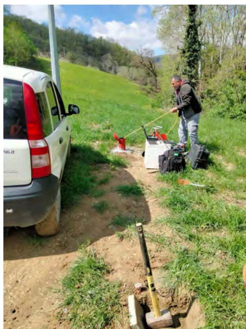
Figura 2: Documentazione fotografica prova down hole s3
