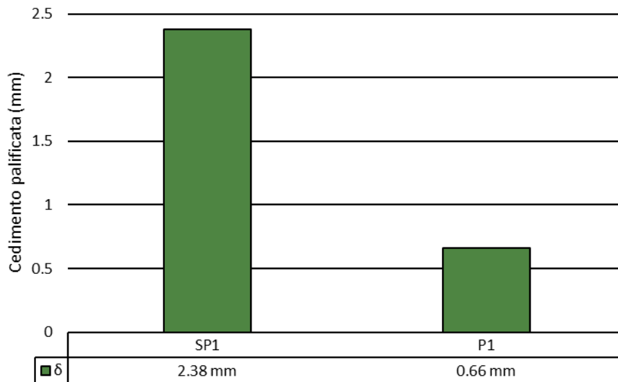
Figura 6.17 Cedimento della palificata in condizioni di SLE
