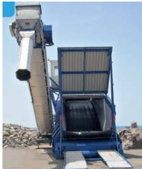
FIGURA 8 Esempio di sistema mobile per la ricezione dei camion e il trasferimento del gesso in stiva
