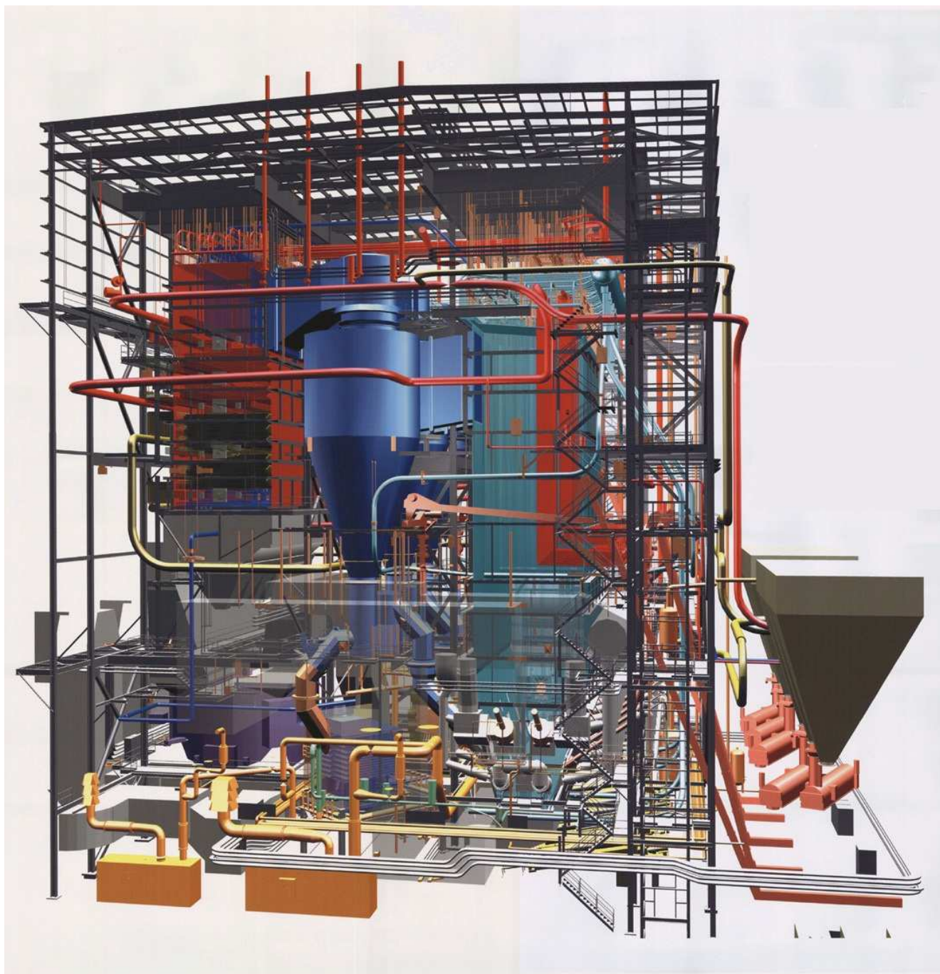
FIGURA 1 Schema del generatore di vapore installato sulla Sezione 2
