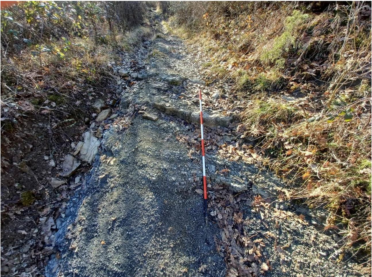
**Figura 3-13 Sequenza di peliti dominanti e strati arenace (spessore medio 5 cm), della potenza complessiva di 5 m, presso la località C. Valdivatica, a monte del tratto terminale dell'alternativa di tracciato**
