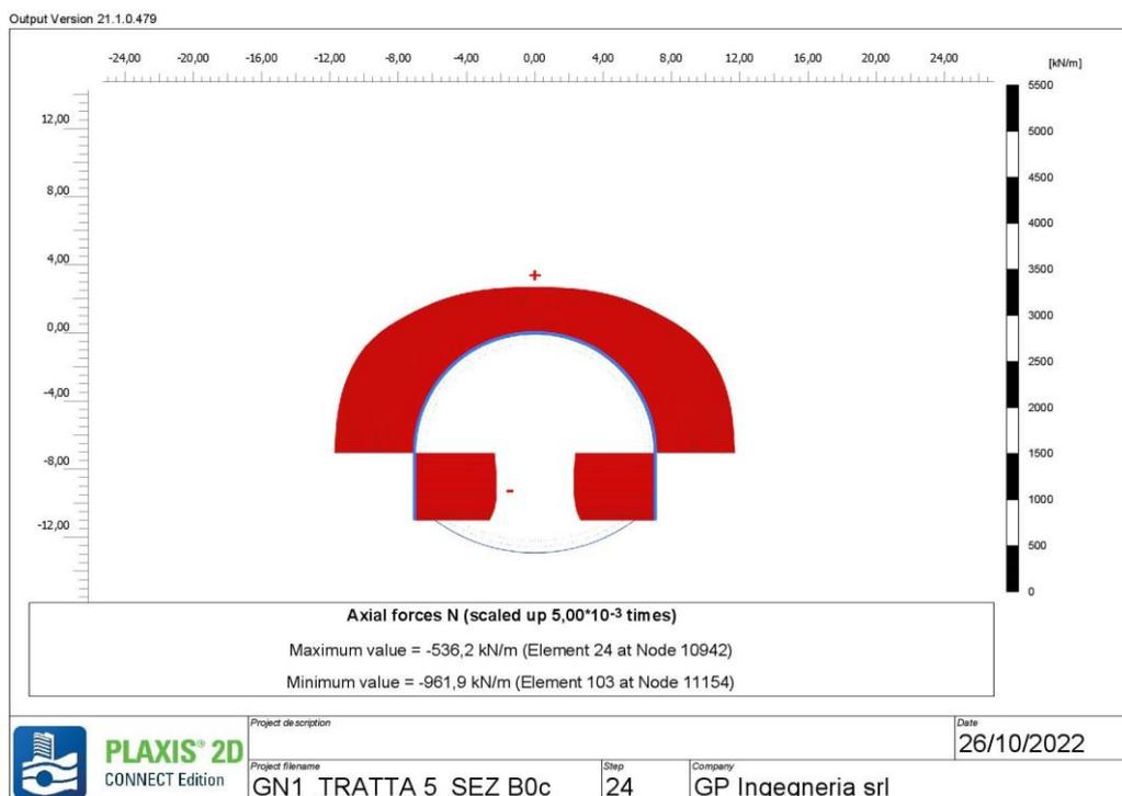
Figura 12-29: diagramma dello sforzo normale – fase 4
