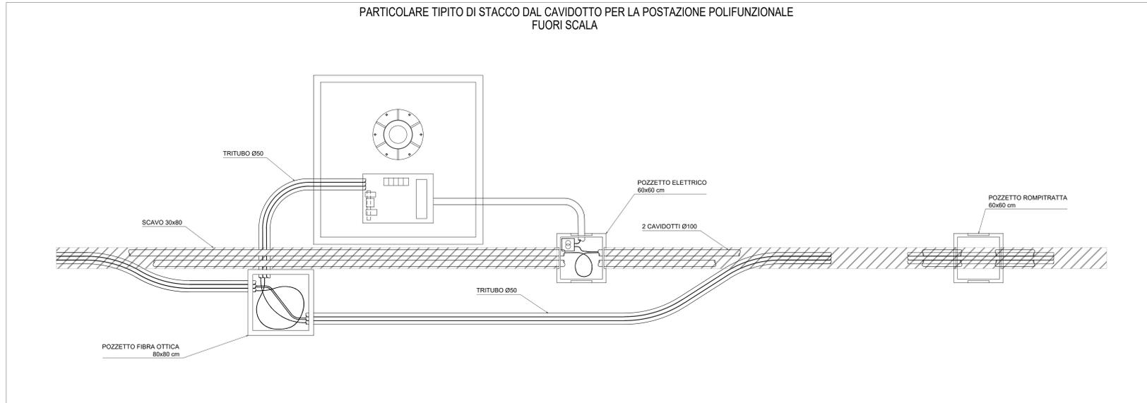
PARTICOLARE POZZETTO ROMPRITRATTA DEL CAVIDOTTO
