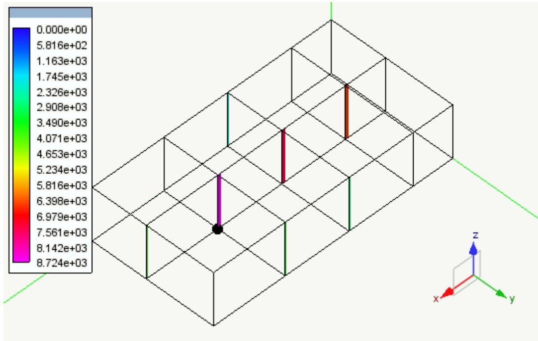
Diagramma degli sforzi assiali piano xz della condizione di carico: PESO SOLAIO [daN]
