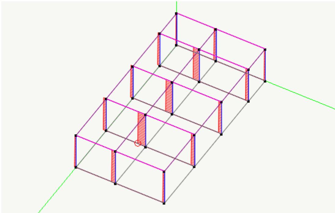
Diagramma di involuppo dello sforzo assiale - piano xz -  $N_{max}=34520.56$  daN
