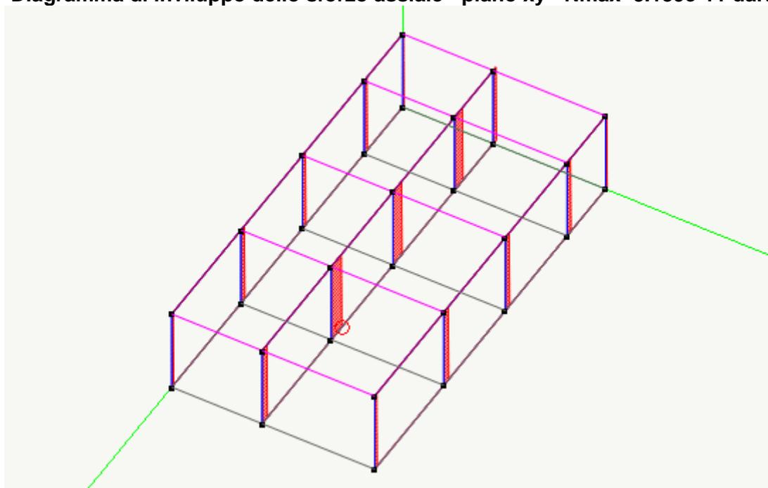
Diagramma di inviluppo dello sforzo assiale - piano xz -  $N_{max}=34520.56$  daN
