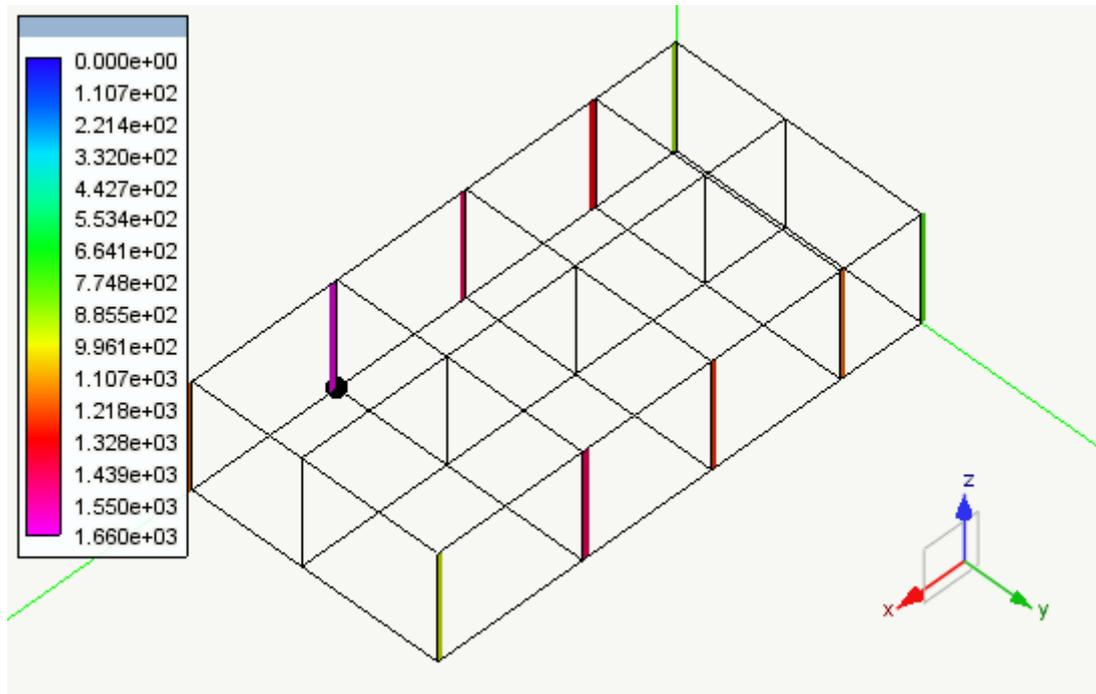
Diagramma degli sforzi assiali piano xz della condizione di carico: Dinamica SLVh Y [daN]
