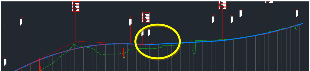
Figura 2: profilo di raffronto Tipo B-Tipo C: l'altimetria degli assi coincide fino alla rotatoria del lotto 3
