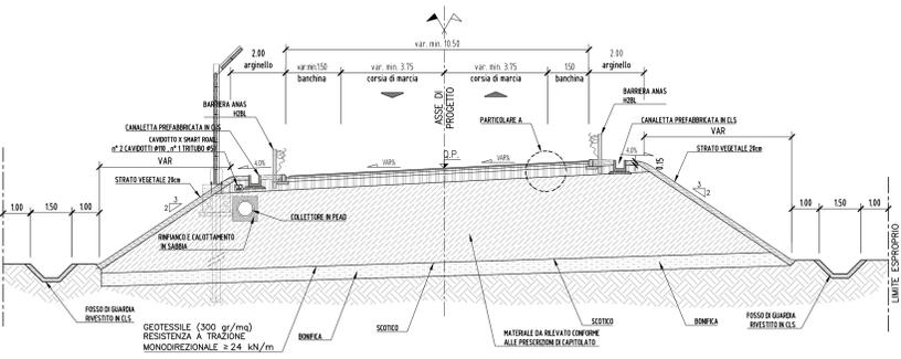
ASSE PRINCIPALE IN RILEVATO CON MURO DI SOSTEGNO .CATEGORIA C1
