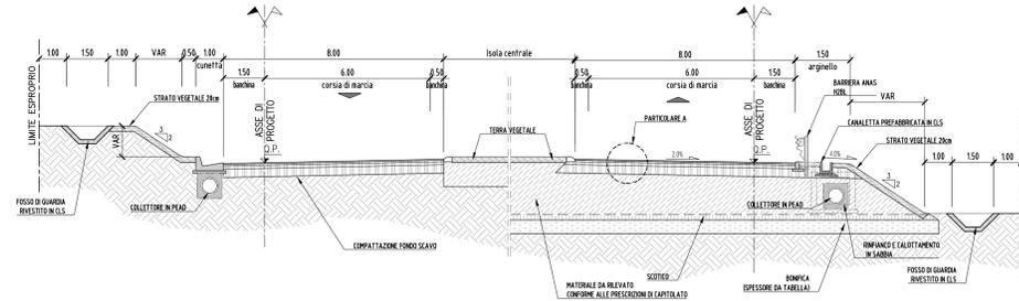
1/2 SEZIONE IN RILEVATO
