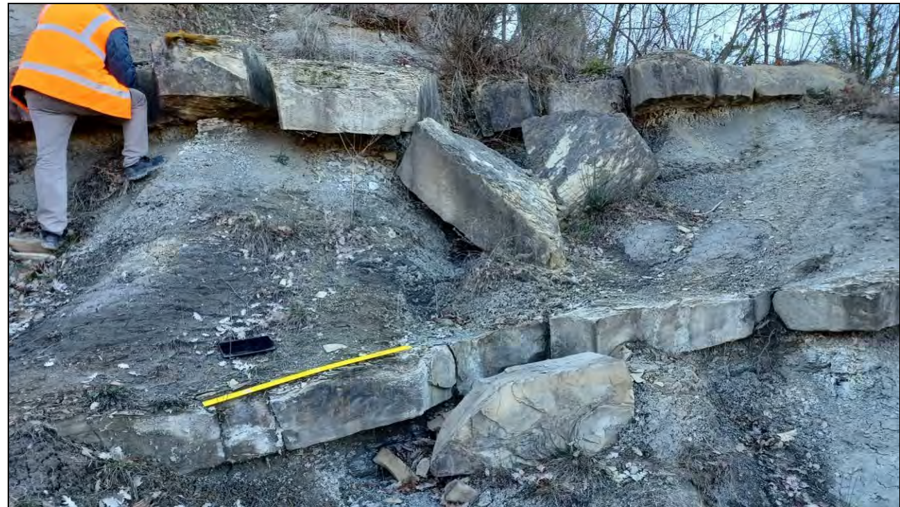
Figura 4–18 Area di distacco con evidente erosione differenziale
