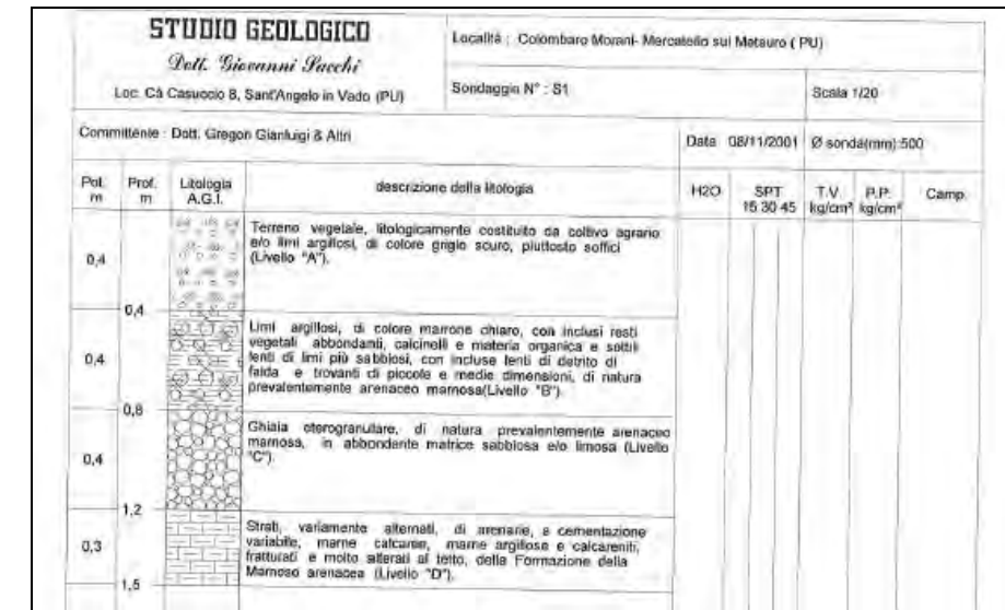
Figura 4-12 Punto di indagine P68 corrispondente al sondaggio S1 (dB comune di Mercatello)
