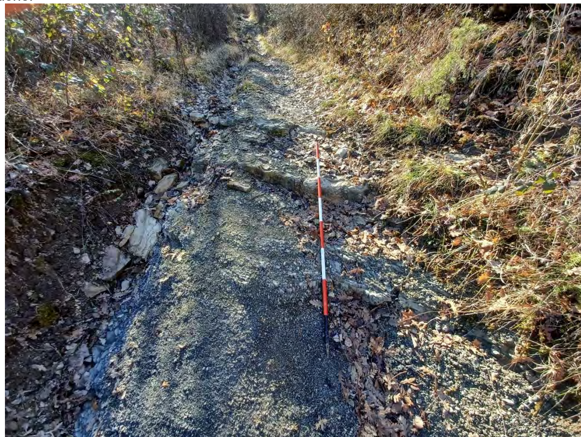
Foto 4-8 Sequenza di peliti dominanti e strati arenacei (spessore medio 5 cm), della potenza complessiva di 5 m, presso la località C. Valdivatica, a monte del tratto terminale dell'alternativa di tracciato
