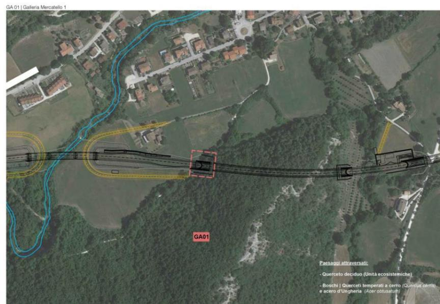
Per l'imbocco della Galleria GA.01 si prevede un becco di flauto che, tagliando in maniera asimmetrico il corpo della sezione tipo, prosegue con un braccio di maggiore lunghezza lato valle che, relazionandosi con il versante, integra in un solo oggetto architettonico anche il contenimento del terreno esistente.
