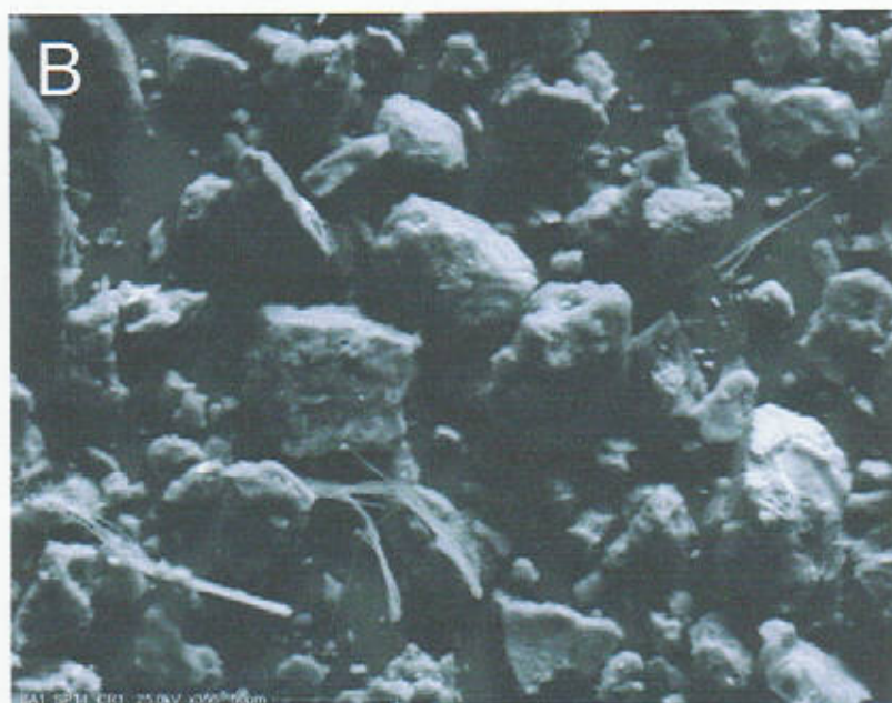
B Microfotografia SEM. Granuli litici e fibre di crisotilo.
