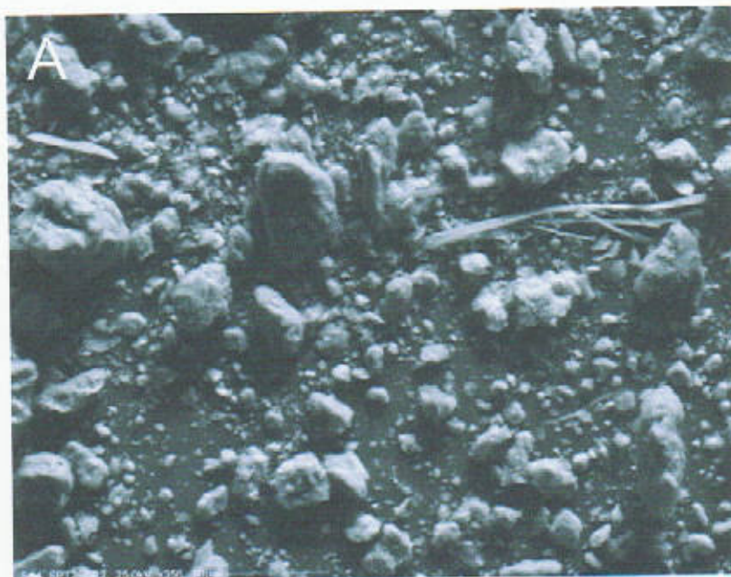
A Microfotografia SEM. Panoramica del campione analizzato. Granuli litici e fibre di crisotilo.
