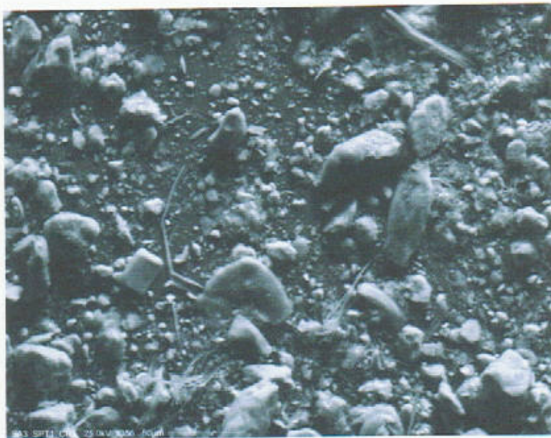
B Microfotografia SEM. Panoramica del campione analizzato. Granuli litici e fibre di crisotilo.
