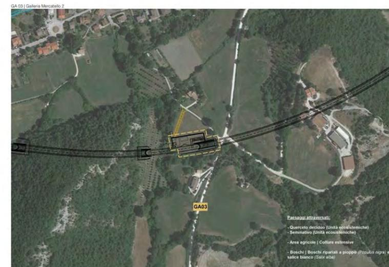
Per quanto riguarda la sagoma architettonica dei due imbocchi si è proceduto, in conformità con gli altri elementi, riproponendo un ingresso con taglio a becco di flauto. L'imbocco GA.02 si trova su un versante scosceso che viene attraversato perpendicolarmente, per cui il piano di taglio della galleria genera una forma simmetrica rispetto all'asse della strada.
