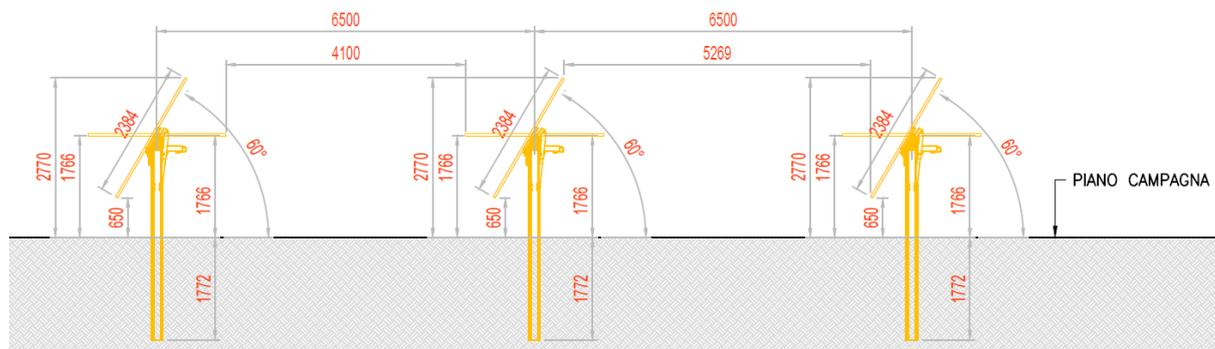
Figura 2.37: Particolare strutture di sostegno moduli tracker
