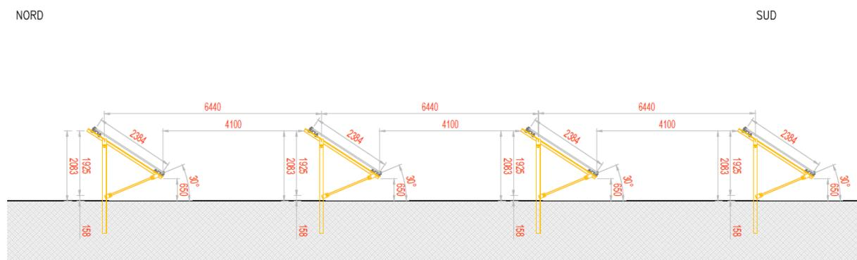
*Figura 2.39: Particolare strutture di sostegno moduli fissi*
