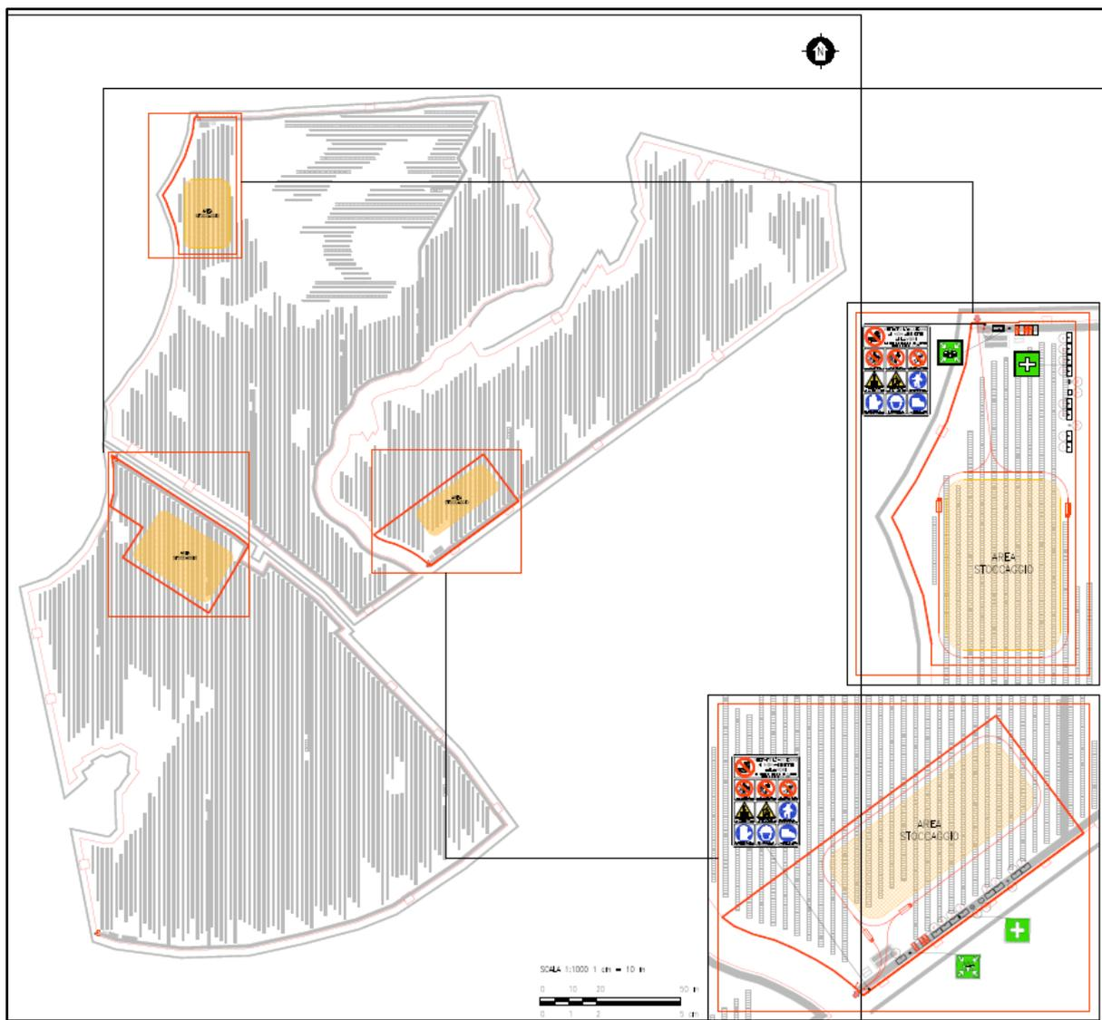
Figura 4.25: Aree di Cantiere previste all'interno dell'Area di Impianto- rif. Elaborato 2983\_5211\_RE\_VIA\_T08\_Rev0\_Planimetria area di cantiere
