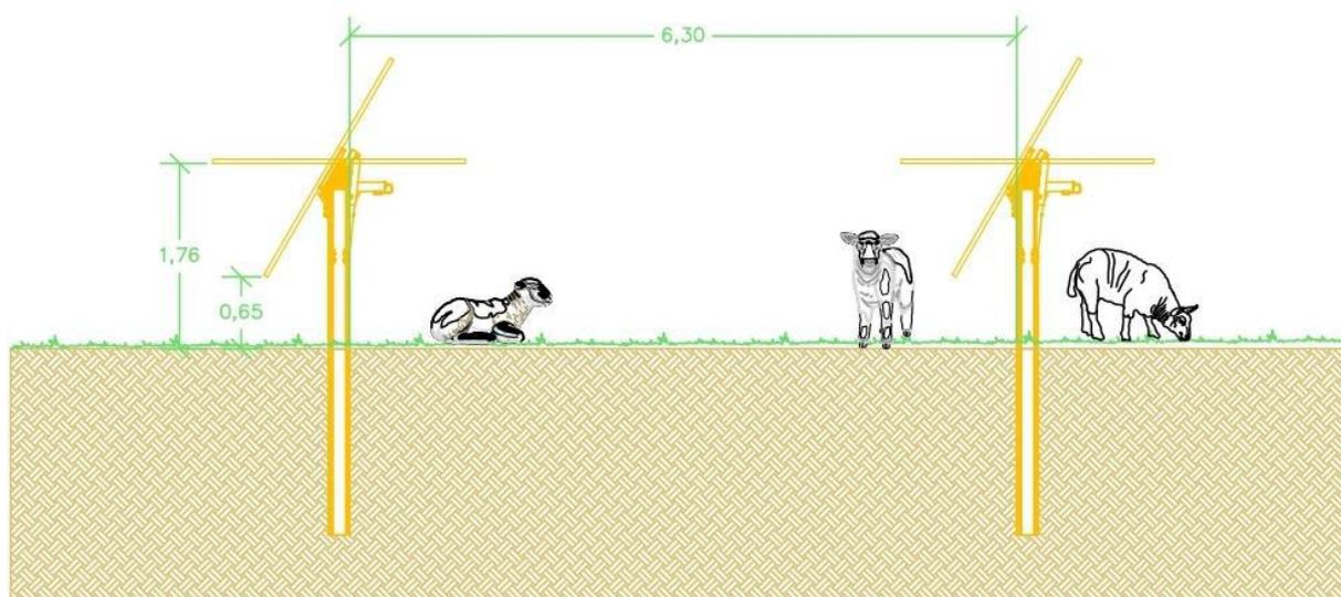
*Figura 2.47: Sezione dell'Area destinata a prato permanente degli ovini che pascolano tra le strutture dell'impianto fotovoltaico*
