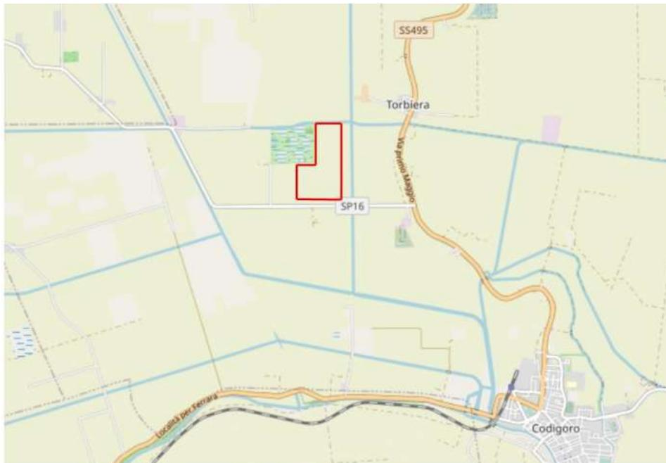
La connessione alla RTN prevede la realizzazione di 3 opere: lo Stallo nella Cabina Primaria (C.P.) 132 kV di Codigoro; l'elettrodotto 132 kV costituito da una terna in cavi sotterranei unipolari e la cabina 132/30 kV nel campo fotovoltaico.
