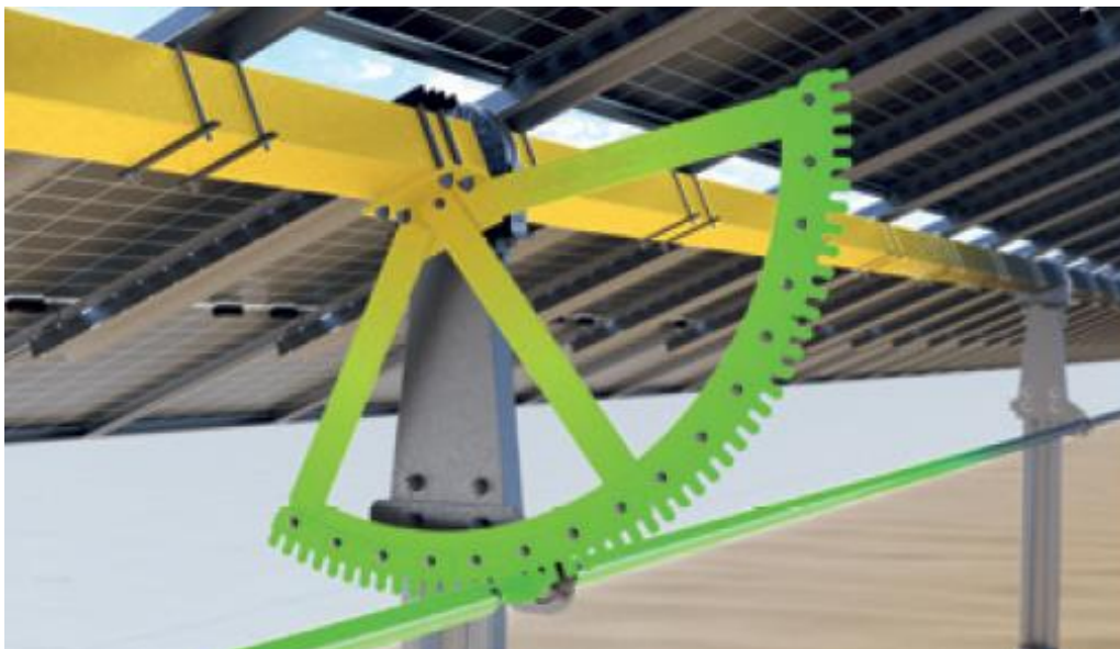
Dettaglio movimentazione con inseguitore monoassiale Est-Ovest
