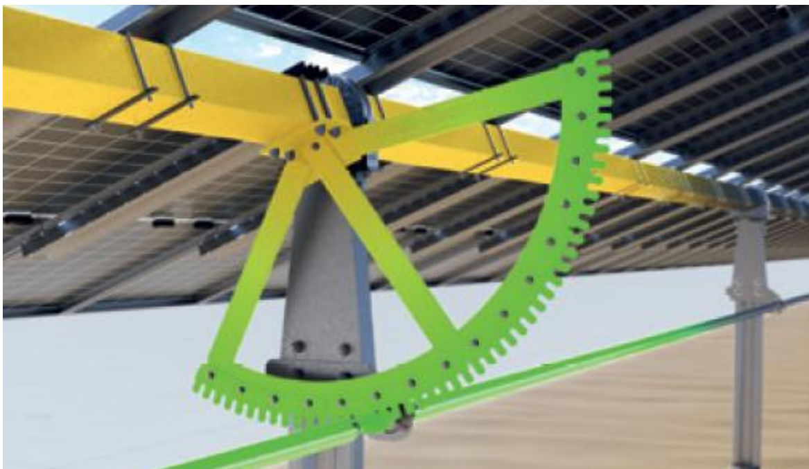
Dettaglio movimentazione con inseguitore monoassiale Est-Ovest
