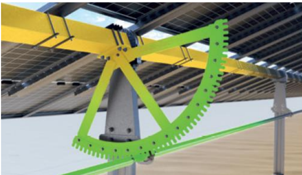
Dettaglio movimentazione con inseguitore monoassiale Est-Ovest
