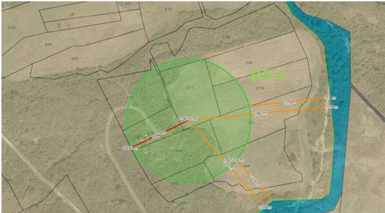
Fig. 2 - Interessamento della fascia di rispetto fluviale di 150 ml con il rotore dell'aerogeneratore BV4.
