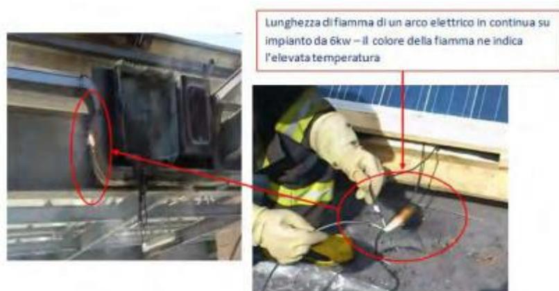
Tali difetti possono generare, durante l'irraggiamento, un arco elettrico capace di perforare il supporto ed innescare il materiale combustibile.
