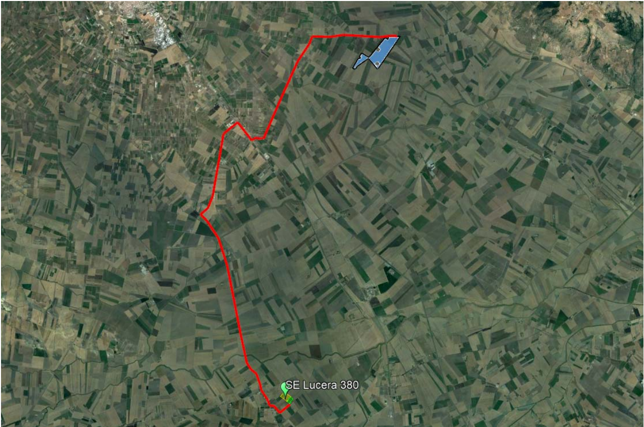
Fig. 5– Tracciato cavidotto MT verso SE
